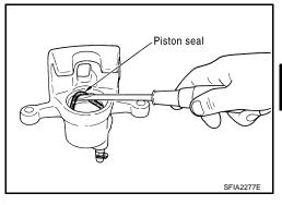
**BRAKE CALIPER ASSEMBLY: Assembly**
