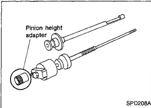
**PINION HEIGHT ADJUSTING WASHER SELECTION**
