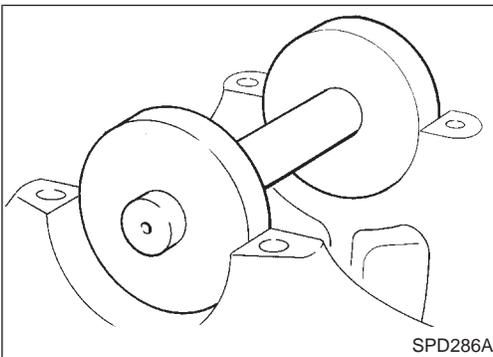
**PINION HEIGHT ADJUSTING WASHER SELECTION**
