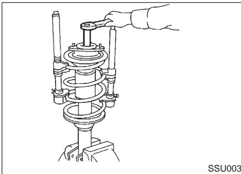
3. Remove piston rod lock nut.
