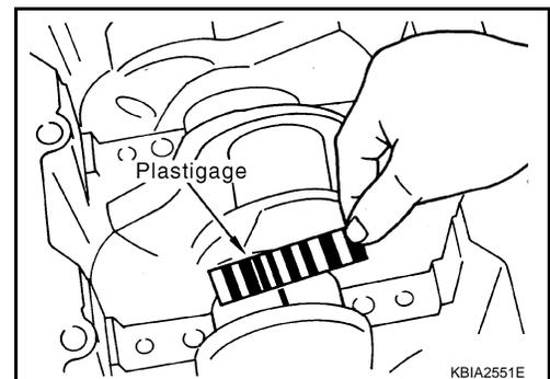
CRUSH HEIGHT OF MAIN BEARING
