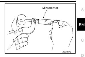
Valve Lifter Hole Diameter
